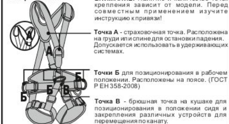
Рис. 5. Способы крепления к анкерным устройствам
