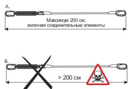
Рис. 9. Использование совместно с амортизаторами
